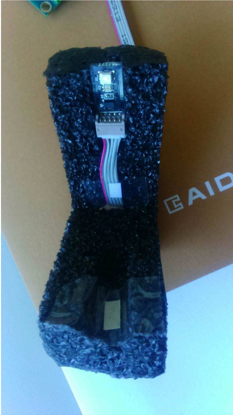
Imagen 19. Vista delantera del módulo DIPP_SENS en funcionamiento y conectado a su cable de comunicaciones.
