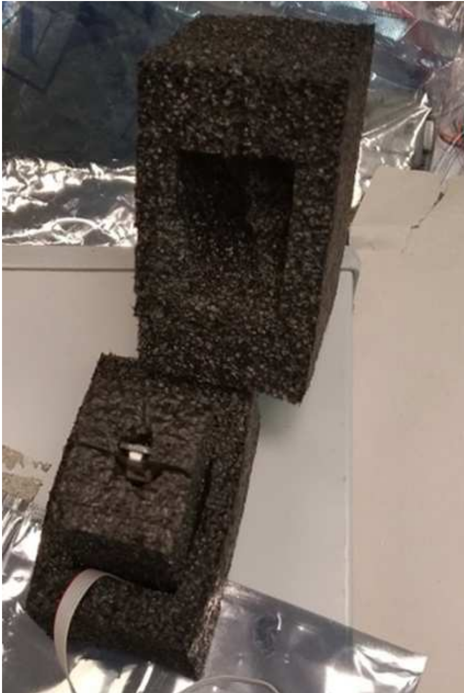
Imagen 25. Espuma de polietileno expandido usada para pruebas preliminares del sensor.
