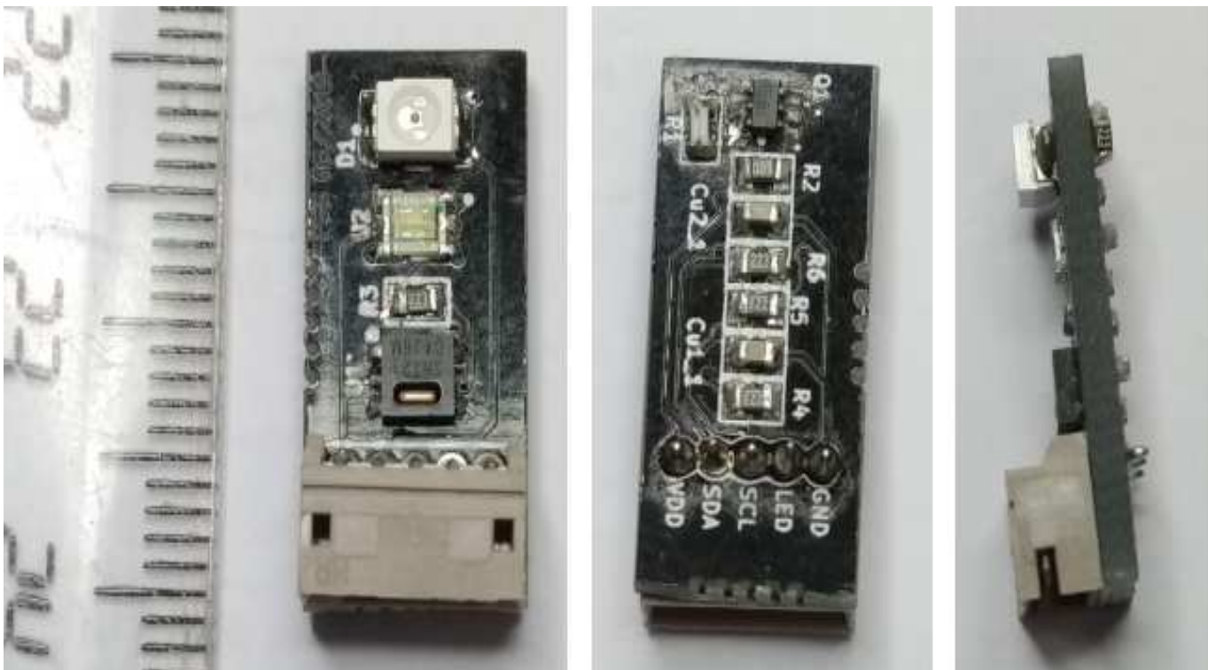
Imagen 18. Vista delantera, trasera y lateral del módulo DIPP_SENS.
