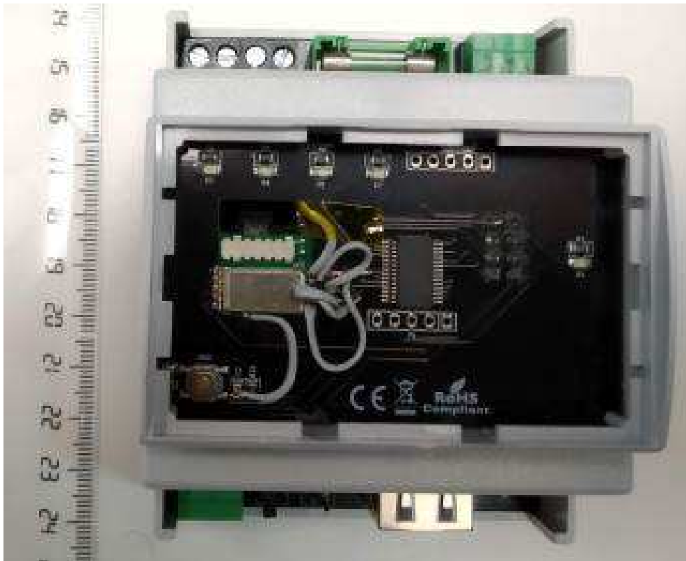
Imagen 23. Vista superior de una PCB del módulo DIPP_ETH.
