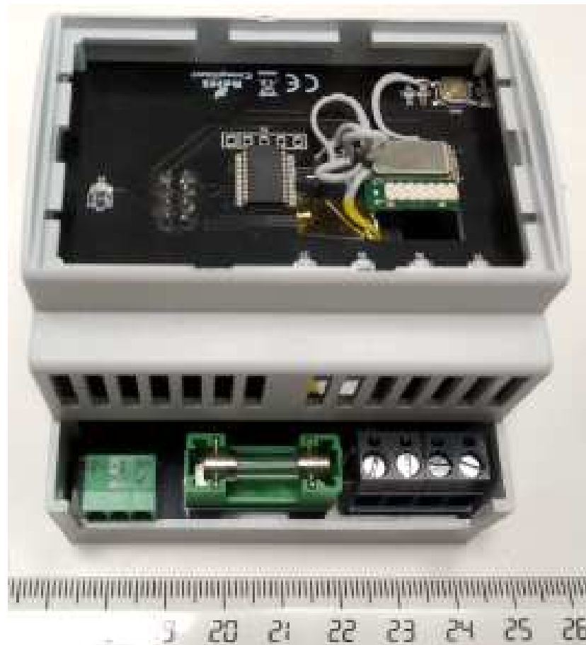
Imagen 24. Vista delantera de un PCB del módulo DIPP_ETH.
