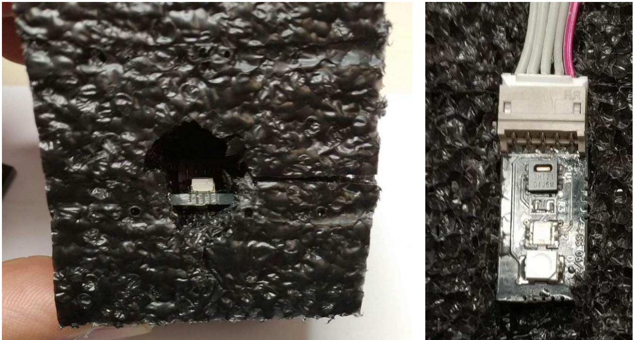
Imagen 26. Prueba del sensor simulando la madera con plástico negro y las termitas con papelitos blancos (sensor en modo de hibernación).
