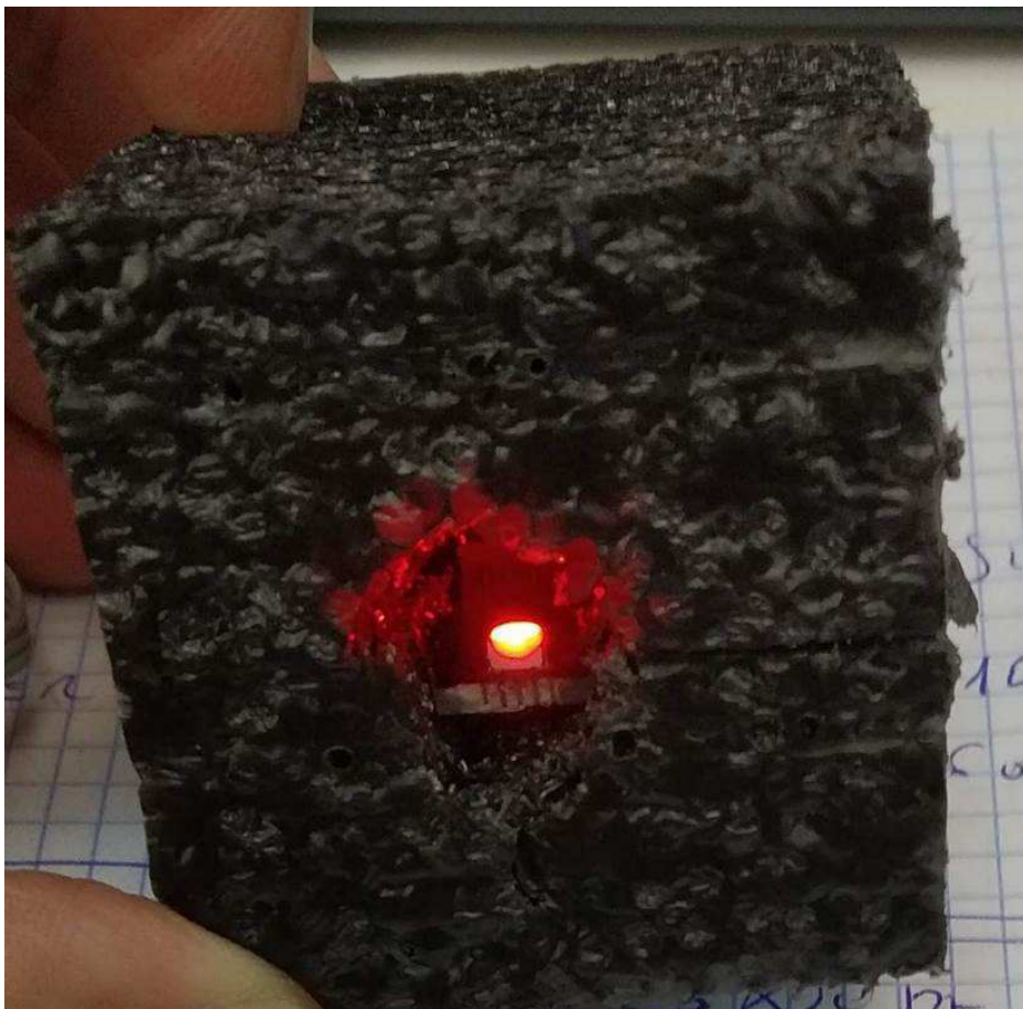
Imagen 27. Prueba del sensor simulando la madera con plástico negro y las termitas con papelitos blancos (sensor encendido y en funcionamiento).
